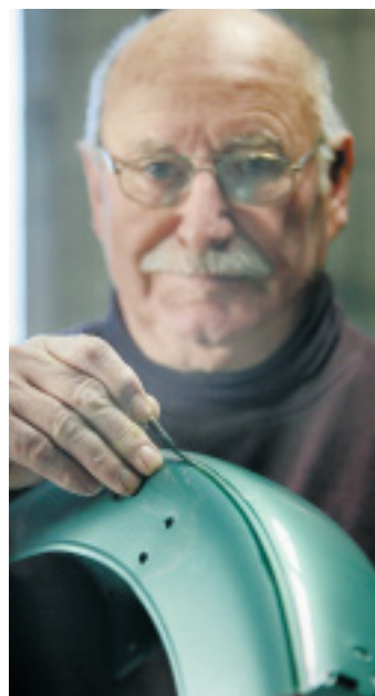
Freihändig: Gerhard Grenzbech zieht Linien auf Schutzbleche.
